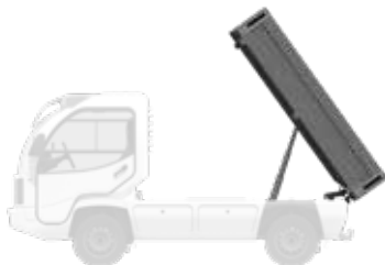
DSK - Pritsche mit 3-Seiten Kipper
