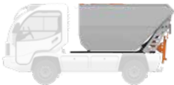
ML - Abfalltransportwanne Hochentleerer mit Mülltonnenlift
